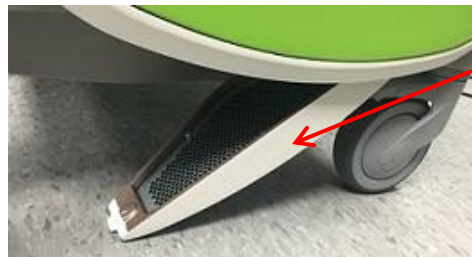
Abbildung 69: Zugang zum unteren Luftfilter
